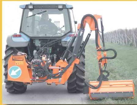
Decespugliatori idraulici con braccio posteriori da 3 a 12 mt versione per poter operare sia a destra che a sinistra di bordi stradali
