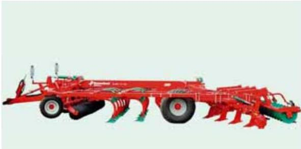
La serie di dischi dentati situata nella parte più prossima alla trattrice permette di eseguire una prima aggressione al residuo colturale a cui seguono progressivamente due ranghi di ancore che operano nello strato superficiale e una serie di ancore che lavorano in profondità, disposte a «V».
