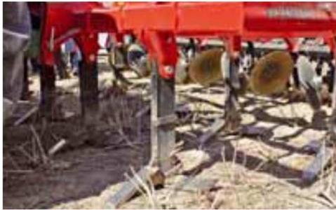
**Ancore diritte:** eseguono una fessurazione del terreno senza rivoltare gli strati lavorati. Sono considerate la soluzione migliore per operare con terreni tenaci in quanto il sovrizzo lasciato dopo la lavorazione è minimo.
