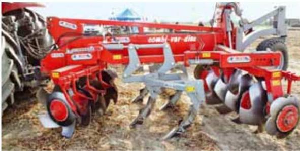
Organi a disco dal profilo aggressivo (tipologia Fleaux) sono in grado di effettuare una lavorazione dello strato superficiale lasciando il compito della lavorazione più profonda a una serie di ancore collocate nel centro dell'attrezzatura. I dischi posteriori, simili agli anteriori completano l'azione di affinamento provvedendo anche a un pareggiamento del terreno lavorato.
