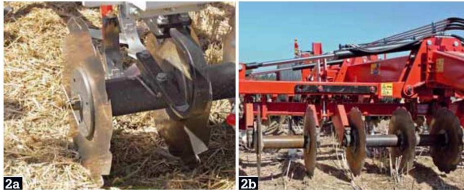
Posteriormente vengono inseriti ancora dischi per l'affinamento o rulli per il mantenimento della profondità
