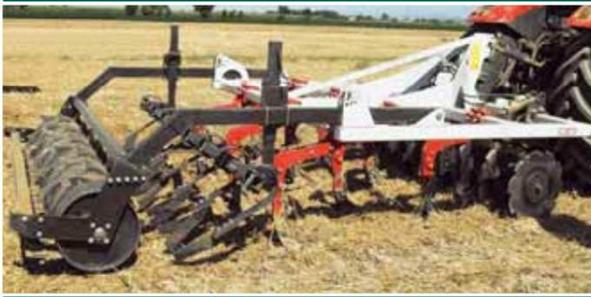
Dischi anteriori di elevato diametro, piatti e con profilo dentato sono inseriti con lo scopo di effettuare un taglio verticale del residuo e del terreno in linea con le ancore posteriori. La dischiera è fissata autonomamente al telaio principale mediante molle a balestra. Le ancore, disposte su tre ranghi e munite di ampie alette sul piede, decompattano il terreno fino a 25 cm di profondità penetrando con facilità nel solco prodotto dal disco.
