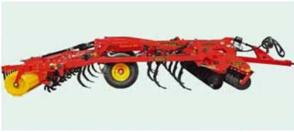
Dischi frontali con inclinazione contrapposta tagliano il terreno e il residuo rimescolandolo superficialmente. L'azione prodotta dalle ancore poste su tre ranghi può arrivare a profondità di 30-35 cm, mentre la successiva azione livellatrice è condotta dai dischi posteriori controllabili idraulicamente in modo continuo. Il rullo finale compatta e livella la superficie.
