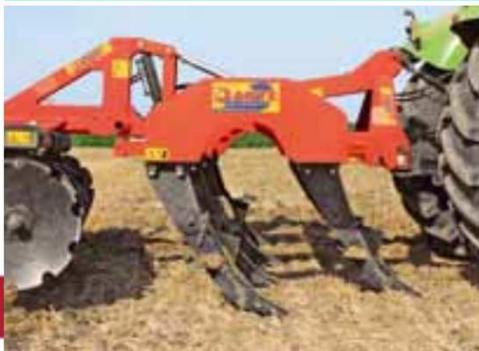
**Ancore inclinate:** l'inclinazione nella parte prossimale al telaio favorisce la penetrazione all'interno del terreno e il suo sollevamento, limitando l'azione lavorante alla rottura e al blando rimescolamento del suo strato superficiale. Maggiore è l'angolo di inclinazione e più aggressiva risulterà la penetrazione nel terreno.
