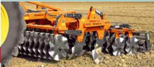
La dischiera anteriore, composta da dischi di grande diametro a profilo ondulato, opera sui primi centimetri di terreno e sul residuo colturale presente in superficie. Le due file di ancore ricurve lateralmente (tipologia Michel) permettono di operare una fessurazione del terreno a una profondità variabile tra 20 e 40 cm senza inversioni degli strati.
