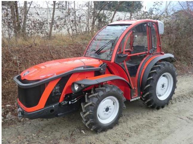
**SPAGAT:** è una cabina no ROPS che protegge l'operatore solamente dagli agenti atmosferici, ma il cui telaio NON è dimensionato per eventuale ribaltamento del trattore.
