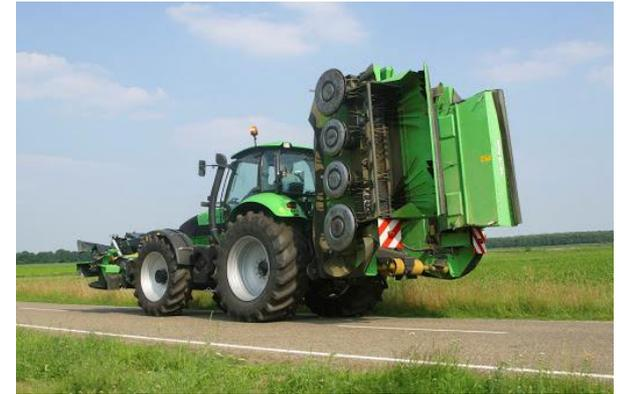
**Attrezzature semiportate:** quelle la cui massa viene parzialmente trasmessa alla strada dalla o dalle ruote equipaggianti l'attrezzatura stessa; in tal caso gli appositi attacchi devono consentire una oscillazione dell'attrezzatura sul piano verticale.
