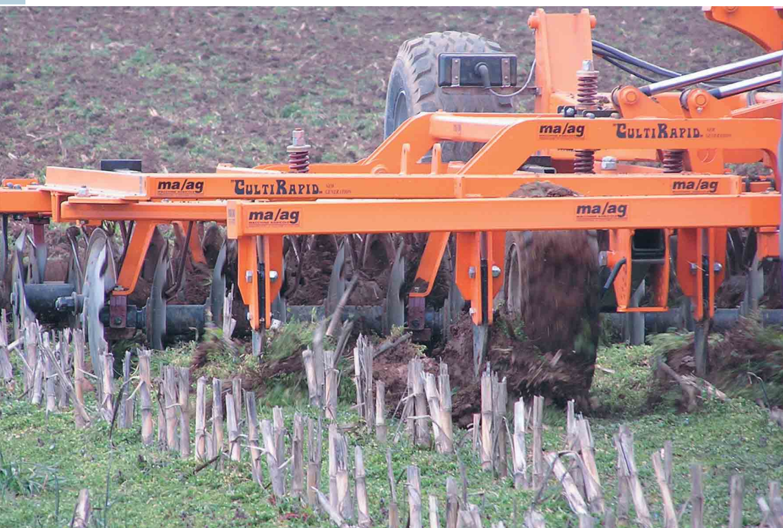
Il combinato Cultirapid New Generation è una macchina innovativa per la minima lavorazione del terreno e la preparazione del letto di semina. The Cultirapid New Generation is a combined minimal soil working equipment
