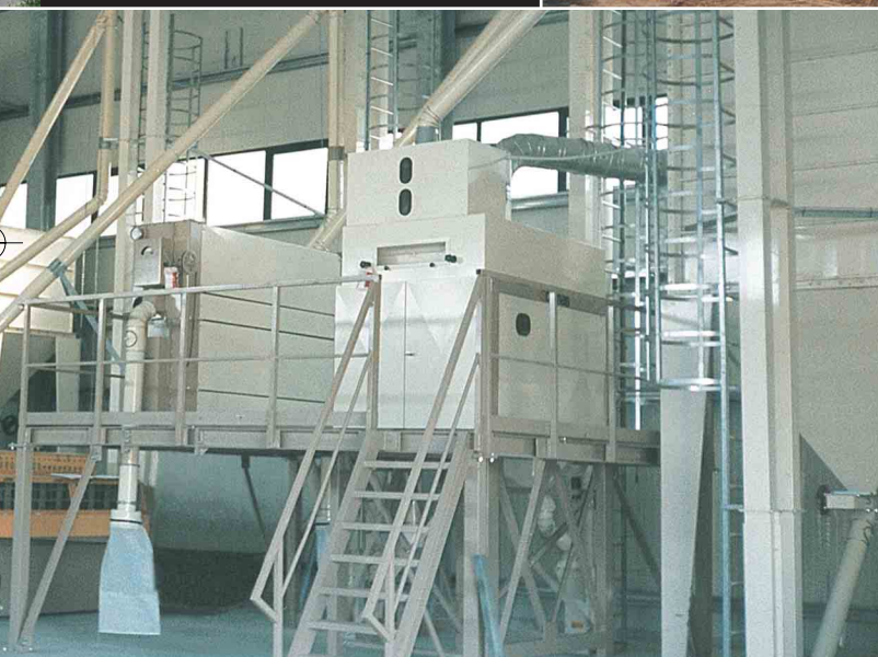
Impianto per la selezione di sementi di grano duro. In primo piano il separatore a crivelli e la batteria di cilindri alveolati (Italia) / In Italy, plant for selection of durum wheat seeds. In the foreground, the sieve separator with incorporated calibration and the bank of indented cylinders
